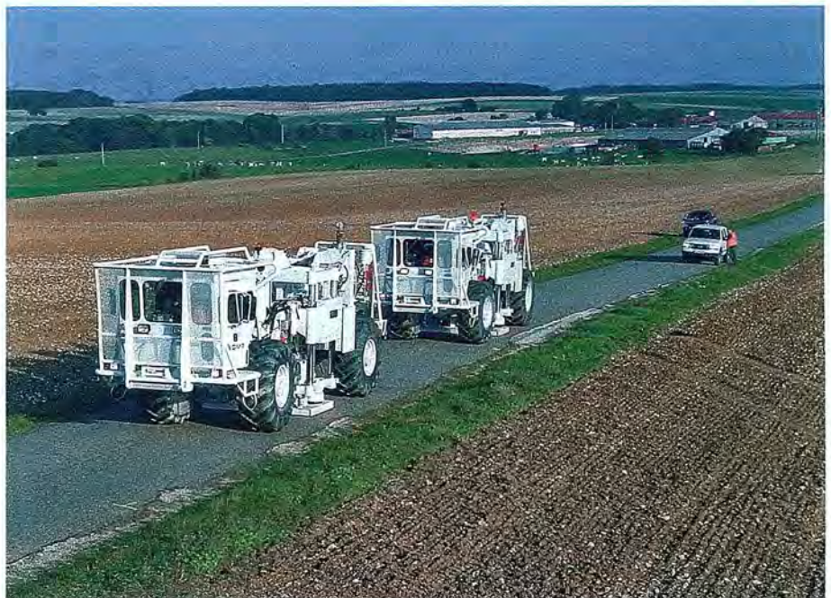
Des camions «vibreurs» ont sillonné la région. Les mesures qu'ils ont collectées ont permis de dresser une cartographie des failles.
